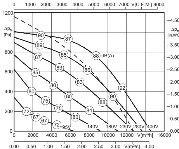
Lufteleistungskennlinie bei radialer Durchströmung / Air performance curve at radial air flow
