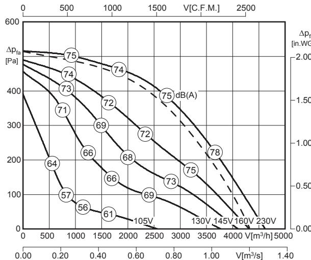
Luftleistungskennlinie bei radialer Durchströmung / Air performance curve at radial air flow
