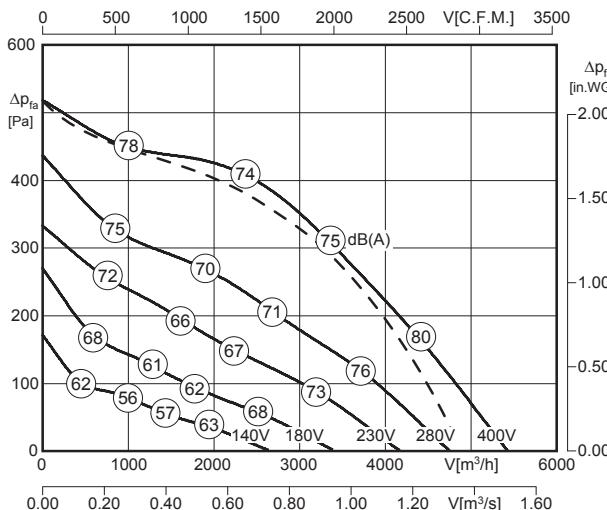
Luftleistungskennlinie bei radikal Durchströmung / Air performance curve at radial air flow
