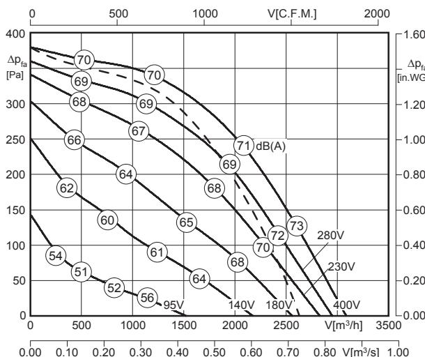
Luftleistungskennlinie bei radikal Durchströmung / Air performance curve at radial air flow
